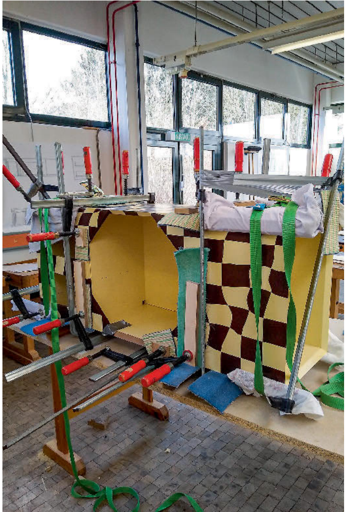
/ Keine optische Täuschung: Spätestens beim Verleimen des Korpus wurden aus den virtuell-visuellen ganz praktische, handwerkliche Probleme ...
