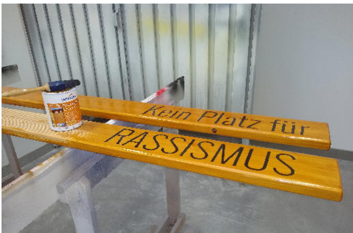
/ Dem für Lärche obligatorischen Bläueschutz durch eine lösungsmittelbasierte Imprägnierung folgte ein zweimaliger Lasuranstrich (Remmers).
