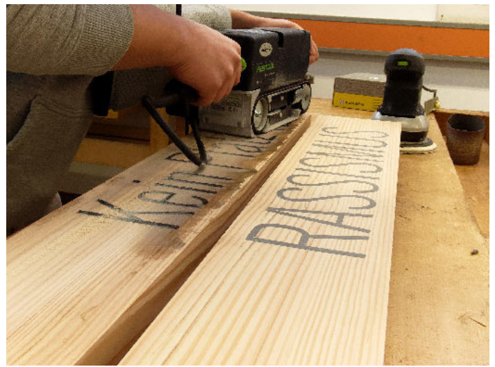
/ Nach dem Aushärten wurde das überschüssige Material mithilfe eines Handbandschleifers entfernt und die Oberfläche mit dem Exzentrerschleifer fein geschliffen.
