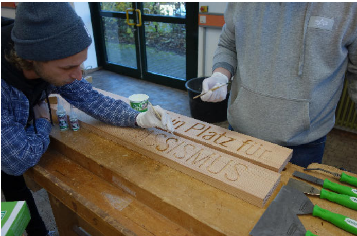
/ In einem ersten Arbeitsschritt wird die Schriftfräsung mit Dry Fix Uni grundiert und der Überschuss nach 20- bis 40-minütiger Einwirkzeit entfernt ...
